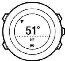
La boussole se met automatiquement en mode économie d'énergie après une minute. Réactivez-la à l'aide du bouton [Start Stop].
