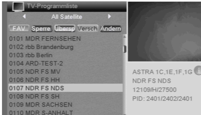
L'émetteur devant être modifié et lequel est sélectionné au moyen des touches ▲ et ▼, est marqué par une barre jaune. L'émission est transmise dans la petite fenêtre sur la droite.
