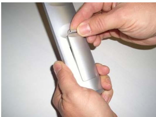
⇒ Placez deux piles dans le compartiment des piles en respectant la polarité indiquée.
