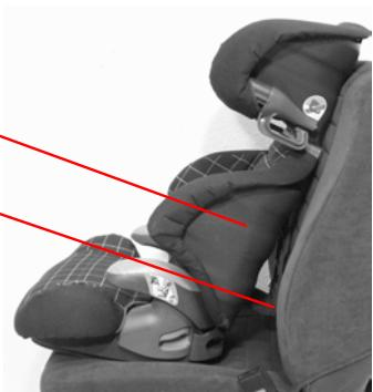
➲ Inclinez à présent le dossier 2 vers l'arrière jusqu'à ce que l'équerre 9 s'appuie à plat sur le dossier du siège du véhicule.
