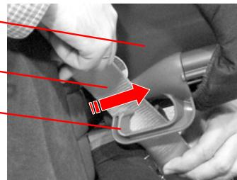
☞ Passez la sangle diagonale **6** dans le support de ceinture rouge foncé **7** de l'appui-tête **3**, jusqu'à ce qu'il glisse derrière l'ergot de sécurité.
