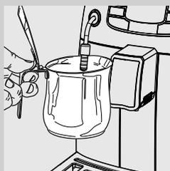
**1** Inserire un contenitore sotto il tubo vapore.
