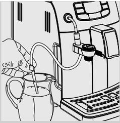
**4** Inserire il tubo di aspirazione nel contenitore del latte.
