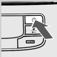
**13** Per accendere la macchina è sufficiente premere il tasto "⏻". Il display indica che è necessario procedere al caricamento del circuito.
