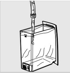
**17** Quando il serbatoio dell'acqua è vuoto estrarlo, risciacquarlo e riempirlo con acqua fresca fino al livello MAX. Reinsierlo nella macchina.
