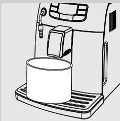
**8** Posizionare un contenitore capiente (1,5 l) sotto il tubo vapore/acqua calda e l'erogatore.
