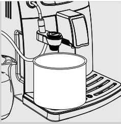
**11** Vuotare il contenitore e riposizionarlo sotto il Montalatte automatico.
