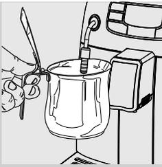
**2** Inserire un contenitore sotto il tubo vapore.
