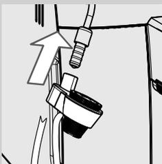
**7** Inserire il Montalatte Automatico nella sede del tubo vapore fino allo scatto in posizione.
