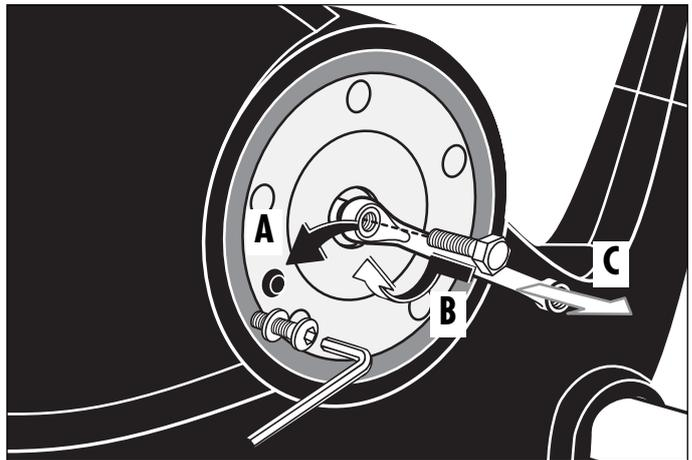
Zum Abziehen des Pedalarms entfernen Sie zuerst die Schutzkappe und Schraube (A). Halten Sie den Pedalarm fest und drehen Sie eine Schraube M12 (gehört nicht zum Lieferumfang) in die Gewindeöffnung (B). Nach einigen Umdrehungen können Sie den Pedalarm abnehmen (C).
