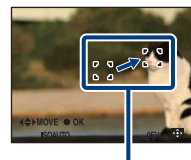
Cornice del telemetro AF (gialla: regolabile, bianca: fissa)
