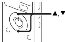
Impostando la funzione DPC (Digital Pitch Control) su “ON”, è possibile regolare la velocità di riproduzione tra +100% e -50% rispetto alla velocità normale. Grazie alla funzione di elaborazione digitale, il messaggio viene riprodotto con toni naturali.
