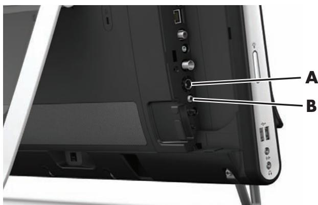
Vous aurez peut-être besoin d'un adaptateur S-vidéo (vendu séparément) pour connecter la sortie vidéo du boîtier décodeur au connecteur d'entrée S-vidéo (**A**).
