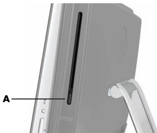
Per espellere un disco, assicurarsi che l'alimentazione sia accesa e premere il pulsante Espelli (**A**) sul lato del drive del disco. È possibile, inoltre, toccare il pulsante **Start**, toccare **Computer**, tenere premuto (o con il mouse fare clic con il pulsante destro) il drive del CD, quindi toccare **Espelli**.
