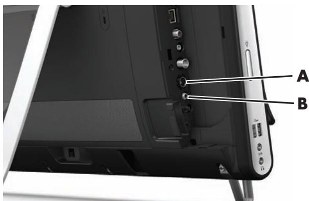
Sie benötigen eventuell einen Composite-Video-zu-S-Video-Adapter (separat erhältlich), um den Video-Ausgang der Set-Top-Box mit dem S-Video In-Anschluss (**A**) zu verbinden.
