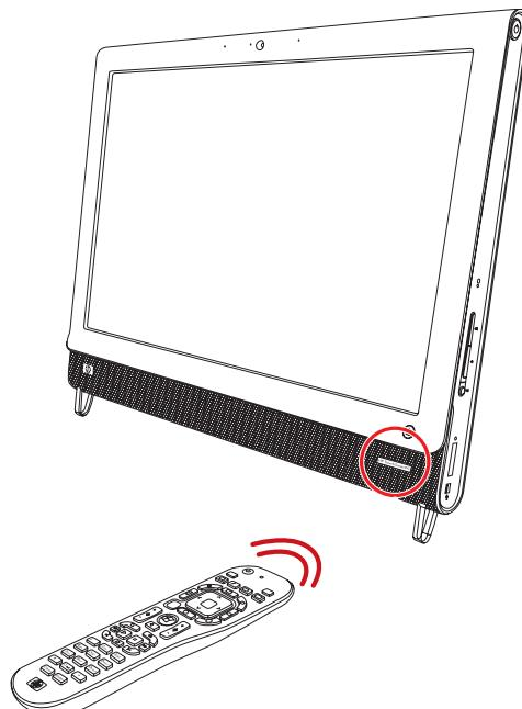
La télécommande fonctionne avec Windows Media Center et d'autres logiciels. Cette télécommande vous permet de naviguer dans votre ordinateur et de le contrôler, tout comme la télécommande d'une télévision permet de parcourir les options de télévision par câble ou de contrôler la lecture d'un film dans un lecteur de DVD.
