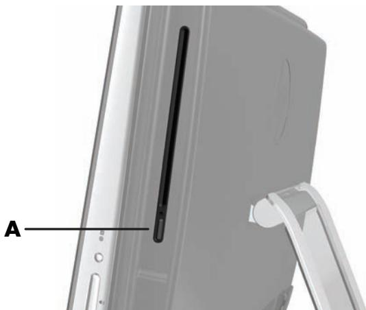
Pour éjecter un disque, assurez-vous que l'appareil est allumé, puis appuyez sur le bouton **Éjection (A)** sur le côté du lecteur. Vous pouvez aussi appuyer sur le bouton **Démarrer**, appuyer sur **Ordinateur**, puis appuyer en maintenant le doigt enfoncé (ou avec la souris, cliquer avec le bouton droit) sur le lecteur CD, et enfin appuyer sur **Éjecter**.
