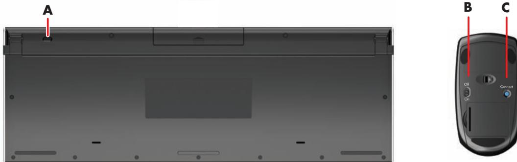
Se non funziona, rimuovere e reinserire il ricevitore della tastiera e del mouse wireless dal retro del computer, quindi sincronizzare la tastiera e il mouse di nuovo.
