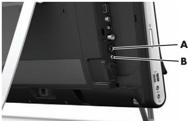
Potrebbe servire un adattatore di video composito a S-Video (visto separatamente) per connettere l'uscita video del set top box al connettore di ingresso S-Video (**A**).
