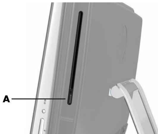
Um einen Datenträger auszuwerfen, vergewissern Sie sich zunächst, dass der Computer eingeschaltet ist, und drücken Sie dann die Auswurfstaste (**A**) an der Seite des Laufwerks. Sie können auch auf die Schaltfläche **Start** und dann **Computer** tippen, das CD-Laufwerk drücken und gedrückt halten (oder es mit der rechten Maustaste anklicken) und anschließend auf **Auswerfen** tippen.
