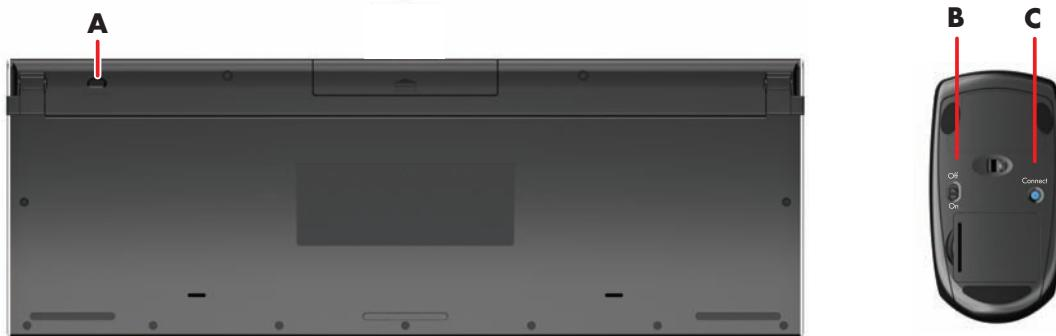
Falls dies nicht funktioniert, trennen Sie den Empfänger der kabellosen Tastatur und der kabellosen Maus von der Rückseite des Computers. Schließen Sie ihn dann wieder an, und synchronisieren Sie Tastatur und Maus erneut.
