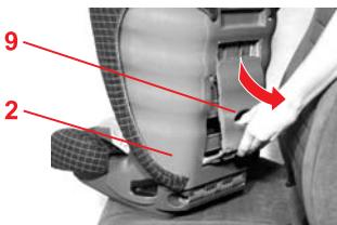
☞ Inclinez à présent le dossier **2** vers l'arrière jusqu'à ce que l'équerre **9** s'appuie à plat sur le dossier du siège du véhicule.
