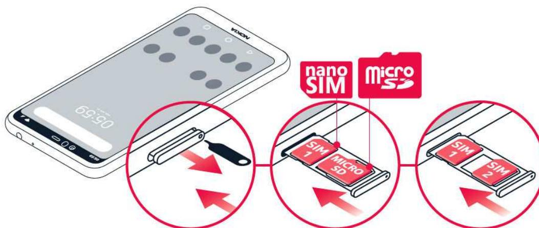
1. Pour ouvrir le plateau pour carte SIM et carte mémoire : poussez la tige de l'outil d'ouverture dans l'orifice de l'emplacement et ouvrez le plateau en le faisant glisser.
