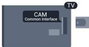
Stecken Sie die CAM-Karte in den Common Interface-Steckplatz des Fernsehers.
