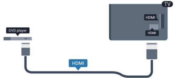
Wenn der DVD-Player über HDMI angeschlossen ist und über EasyLink CEC verfügt, können Sie den Player mit der Fernbedienung des Fernsehers steuern.
