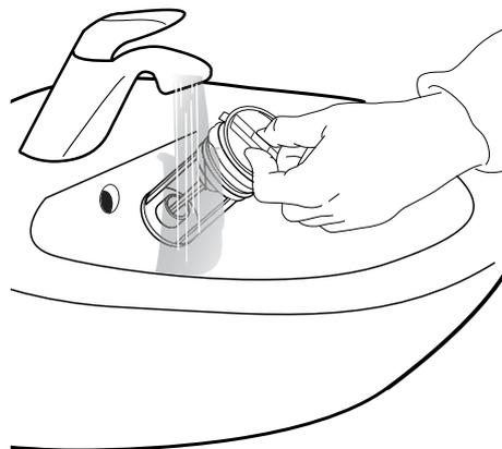
**6.** Setzen Sie den Wasserfilter ein und installieren Sie erneut den Sockel: Setzen Sie den Wasserfilter wieder ein, indem Sie ihn im Uhrzeigersinn drehen. Stellen Sie sicher ihn soweit wie möglich hineinzudrehen; der Filtergriff muss in vertikaler Position sein. Um die Wasserdichtigkeit des Wasserfilters zu testen, können Sie ungefähr 1 Liter Wasser in das Waschmittelfach füllen. Dann den Sockel erneut installieren.
