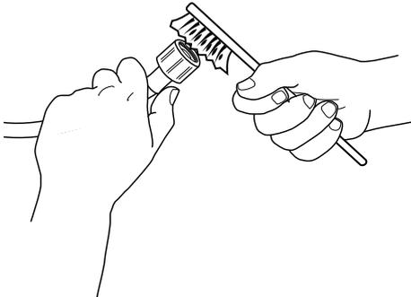
**3.** Schrauben Sie nun den Zulaufschlauch von der Rückseite der Waschmaschine mit der Hand ab. Ziehen Sie das Filtersieb mit einer Zange aus dem Ventil auf der Rückseite der Waschmaschine heraus und reinigen Sie es vorsichtig.
