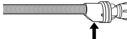
Für Wasserstoppschläuche: Überprüfen Sie das kleine Kontrollfenster des Sicherheitsventils (siehe Pfeil). Wenn es rot ist, wurde die Funktion zum Wasserstopp ausgelöst und der Schlauch muss durch einen neuen ersetzt werden.
