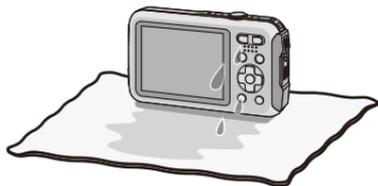
**4 Controllare che non vi siano goccioline d'acqua, aprire lo sportello laterale e rimuovere le medesime o la sabbia usando un panno asciutto e morbido. (P137)**
