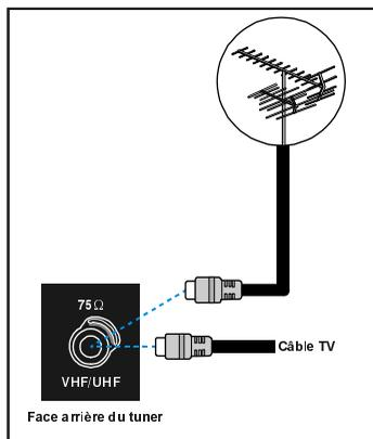
Branchez le câble d'antenne ou câble TV dans la prise d'entrée RF à l'arrière du tuner ainsi que la fiche de sortie TV des autres appareils (VCR, DVB, etc.).
