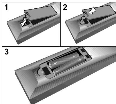
**REMARQUE** : En cas de non-utilisation prolongée, retirez les piles de la télécommande, faute de quoi les piles risquent de couler et de causer des dommages.
