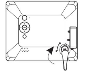
Fissare il piede, ruotare il piede in senso orario. Per rimuoverlo girare in senso antiorario.
