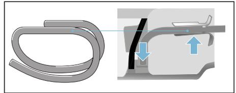
5. Befestigen Sie den Ablaufschlauch mit der anderen Seite je nach Anschluss-Situation A, B oder C mit dem restlichen Zubehör.
