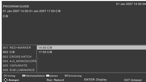
Drücken Sie die **●**-Taste, um die Parameter für die Aufnahme festzulegen. Sie können die Zeit für die Aufnahme einstellen. Die programmierte Aufnahme ist möglich, wenn das TV-Gerät eingeschaltet ist oder sich im Standby-Modus befindet. Wenn die Aufnahme im Standby-Modus beginnt, wird auf dem Bildschirm kein Bild angezeigt und es ist kein Ton zu hören.
