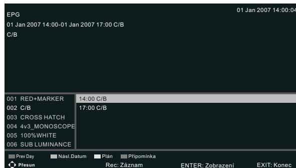
Stiskem tlačítka ● nastavte parametry záznamu. Můžete nastavit čas záznamu, který se má provést. Televizor umožňuje naplánování záznamu při zapnutí nebo v pohotovostním režimu. Pokud záznam proběhne v pohotovostním režimu, nebude přehráván obraz a zvuk.
