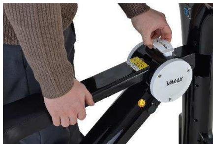
3. Est rabattu le siège, tournez le guidon avec les deux mains à droite ou à gauche. Placer le véhicule sur la roue arrière et plier le guidon jusqu'à ce que le verrou de pliage se ferme.
