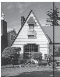
L'échantillon imprimé comporte une ligne verticale lorsque la bande de verre présente des saletés ou du liquide de correction.
