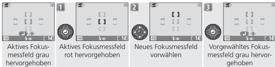
Solange ein Fokusmessfeld rot hervorgehoben wird, können keine Einstellungen für Blitz, Selbstauslöser, Makroaufnahmen oder Belichtungskorrektur vorgenommen werden. Um diese Funktionen einstellen zu können, müssen Sie das rot hervorgehobene Messfeld mit der Mittelstaste des Multifunktionswählers auswählen.
