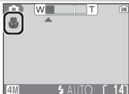
Legen Sie den Bildausschnitt fest. Die NahaEinstellgrenze (die kürzeste Distanz, auf die die Kamera scharfstellen kann) ist abhängig von der gewählten Brennweite. Wenn Sie das Objektiv in eine Position zoomen, bei der das Symbol grün angezeigt wird, kann die Kamera auf Objekte mit einem Abstand von 1 cm oder mehr zum Objektiv scharfstellen. Wenn das Symbol rot hervorgehoben wird, kann die Kamera nicht auf Objekte in einem Abstand von weniger als 1 m fokussieren.
