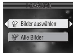
Wenn keine Speicherkarte in die Kamera eingesetzt ist, werden die Bilder aus dem internen Speicher gelöscht. Bei eingesetzter Speicherkarte werden die Bilder von der Speicherkarte gelöscht.
