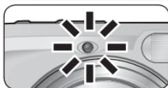
Während der Vorlaufzeit blinkt die Selbstauslöser-Kontrollleuchte an der Vorderseite der Kamera. In der letzten Sekunde leuchtet die Lampe konstant, um zu signalisieren, dass die Kamera im nächsten Moment auslöst.
