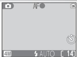
Drücken Sie den Auslöser bis zum ersten Druckpunkt, um den Autofokus zu aktivieren und die Belichtung zu messen.
