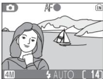
Die Messwerte für Fokus und Belichtung bleiben fixiert, solange der Auslöser in dieser Position gehalten wird.\*
