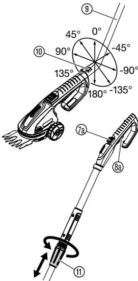
Der GARDENA Teleskop-Drehstiel Art. 8899, bzw. die Accu-Schere, kann in 45°-Schritten montiert werden. Der Drehstiel lässt sich stufenlos in der Länge (85 – 120 cm) verstellen und so individuell auf die Körpergröße anpassen.
