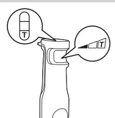
Cet appareil est équipé d'un interrupteur de déclenchement et d'une indication visuelle de la vitesse sur le dessus de l'appareil.
