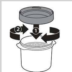
**8** Fixez le compartiment à croûtons en le tournant dans le sens des aiguilles d'une montre.
