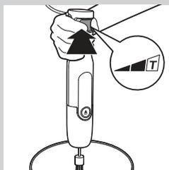
**6** Actionnez l'interrupteur de déclenchement.
