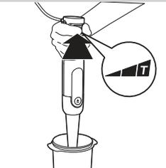
**5** Pour allumer l'appareil, actionnez l'interrupteur de déclenchement. Vous pouvez augmenter la vitesse en appuyant davantage sur l'interrupteur.
