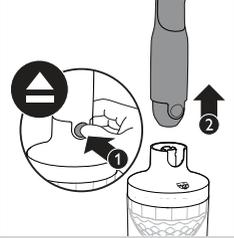
**8** Appuyez sur le bouton de déverrouillage pour retirer le bloc moteur de l'unité d'entraînement.
