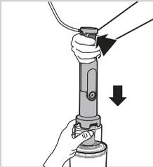
**9** Maintenez le bol du hachoir et la cheminée de remplissage d'une main et actionnez l'interrupteur de déclenchement avec majeur de l'autre main. Poussez le légume vers le bas en même temps.
