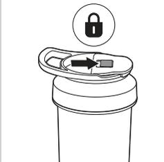
**9** Fermez le bec verseur et verrouillez-le poussant la glissière de verrouillage en position de verrouillage.
