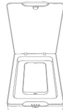
**2. Telefon in UV-Desinfektionsgerät legen und Taste drücken**
