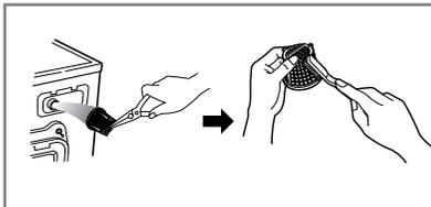
**3.** Den Filter mit einer harten Bürste reinigen.
