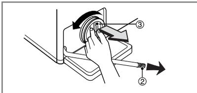
**2.** Den Ablaufstopfen (2) entfernen, um das Wasser abfließen zu lassen. Davor eine Schüssel o.ä. unterstellen, damit kein Wasser auf den Boden fließt. Wenn kein Wasser mehr ausfließt, den Pumpenfilter (3) nach links drehen und öffnen.
