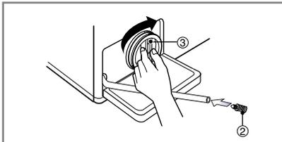
**4.** Nach dem Reinigen den Pumpenfilter (3) im Uhrzeigersinn hineindrehen und den Ablaufstopfen (2) wieder einsetzen. Dann den unteren Deckel schließen.
