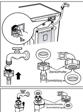
► Diese Maschine ist auf einen Wasserdruck von 30 kPa bis 1000 kPa (0,3 ~ 10 kgf/cm<sup>2</sup>) ausgelegt.
