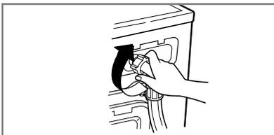
**4.** Den Wasserzulaufschlauch abschrauben.
