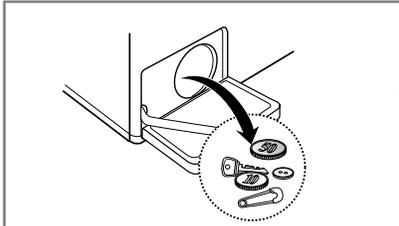
**3.** Fremdkörper aus dem Pumpenfilter (3) entfernen.
