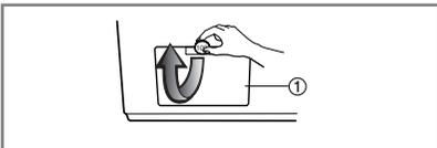
**1.** Den unteren Deckel (1) mit einer Münze öffnen. Den Ablaufstopfen (2) drehen und zusammen mit dem Schlauch herauszuziehen.
