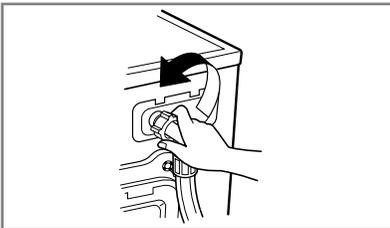
**2.** Den Wasserzulaufschlauch abschrauben.
