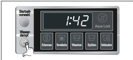
Durch Drücken der Waschen mit Wasserdampf-Taste kann die Waschfunktion ausgewählt werden. Ist Waschen mit Wasserdampf ausgewählt, leuchtet die Waschen mit Wasserdampf-LED.
