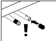
Die traditionellen Doppelbrenner sind bei der Luftzufuhr mit zwei Drahtgittern geschützt. Die Drahtgitter halten Spinnen, bei nichtgebrauch, vor dem eindringen ab und müssen daher zwingend montiert werden.
