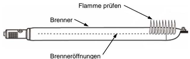
Falls eines oder mehrere der folgenden Anzeichen auftritt, handelt es sich aller Wahrscheinlichkeit nach um eine Blockierung der Venturiröhren. Sofort das Gas abschalten und die Venturiröhren reinigen (siehe "Reinigung und Unterhalt", Seite 7).
