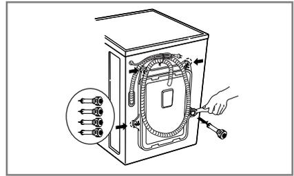
1. Das Gerät ist durch 4 Spezialschrauben gesichert, um Transportschäden zu verhindern. Vor der Inbetriebnahme die Schrauben zusammen mit den Gummipropfen entfernen.
