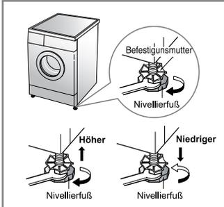
2. Bodenebenheiten durch Drehen der Nivellierfüße ausgleichen (keinesfalls Holz usw. unter die Füße schieben). Sicherstellen, dass alle vier Füße den Boden berühren. Dann mit einer Wasserwaage sicherstellen, dass das Gerät waagrecht steht.
