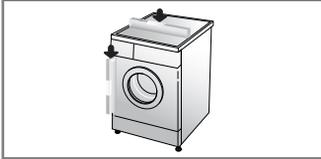
1. Das korrekte Nivellieren oder Ausrichten der Waschmaschine verhindert übermäßiges Geräusch und starke Vibration. Das Gerät auf festem, flachem Untergrund stellen - am besten in eine Ecke.
