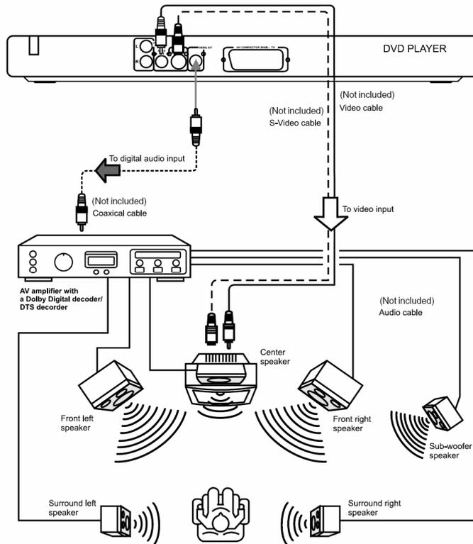
Parallelamente e contemporaneamente al televisore, si può riprodurre l'audio tramite un impianto stereo-surround collegato.
