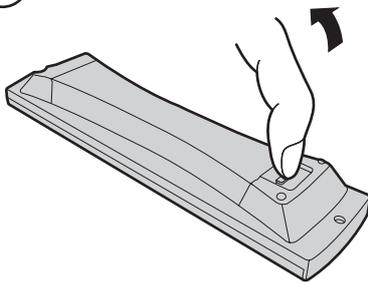
Ziehen Sie am Haken und halten Sie diesen fest. Öffnen Sie danach den Batteriefachdeckel.
