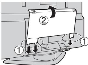
1. Die Klammern (an drei Punkten) auf der Unterseite einsetzen.
