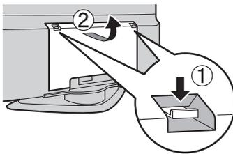
1. Drücken Sie die Haken nach unten und ziehen Sie die Abdeckung vorsichtig nach vorn, um die Klammern (an drei Stellen) zu lösen.
