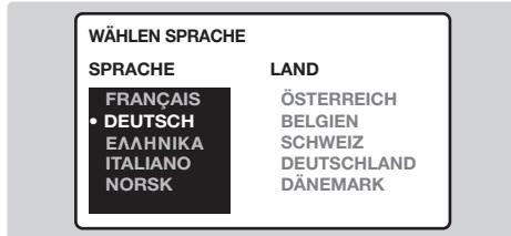
Wird dieses Menü nicht angezeigt, halten Sie die Tasten - und + des Fernsehgerätes 8 Sekunden lang gedrückt. Das Menü wird hierauf angezeigt.
