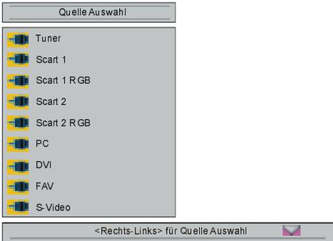
In dem Menü wählen Sie mit den Tasten „▲“ / „▼“ eine Signalquelle aus, und drücken Sie die Taste „▶“, um diese Signalquelle aufzu-rufen. Als Signalquellen stehen **Tuner**, **Scart 1**, **Scart 1 RGB**, **Scart 2**, **Scart 2 RGB**, **PC**, **DVI**, **FAV** und **S-Video**. Zur Verfügung. Neun dieser Optionen sind gleichzeitig im Menü zu sehen. Die übrigen Optionen erreichen Sie mit den Tasten „▲“ / „▼“.
