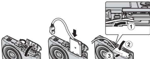
Assicurarsi che il connettore di alimentazione sia inserito completamente nell'apposito alloggiamento prima di inserire l'adattatore CA nel vano batteria. Inoltre, verificare che il cavo del connettore di alimentazione sia inserito completamente nell'alloggiamento del vano batteria prima di chiudere il coperchio del vano batteria/alloggiamento card di memoria. Se una parte del cavo fuoriesce dagli alloggiamenti, quando si chiude il coperchio si potrebbe danneggiare il coperchio o il cavo.
