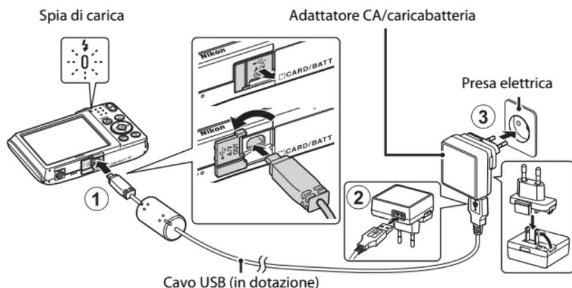
Se la dotazione della fotocamera comprende un adattatore per spina\*, innestarlo saldamente sull'adattatore CA/ricaricabatteria. Se si tenta di rimuovere con forza l'adattatore per spina una volta che i due componenti sono collegati, si potrebbe danneggiare il prodotto.
