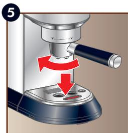
5 Entfernen Sie den Siebträger.
