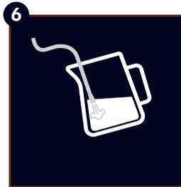
Um die Milch aufzuschäumen, legen Sie das Dampfausgaberohr auf der Oberfläche: so vermischt sich die Luft mit der Milch und dem Dampf.
