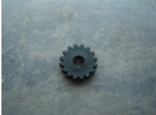
8. Pour poser la fermeture vous devez placer la petite roue dentée avec le creux vers le bas.
