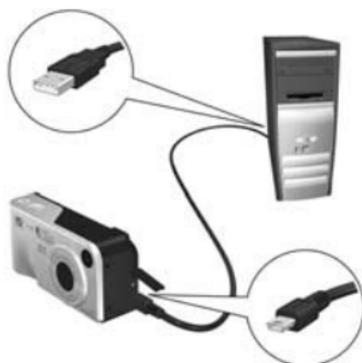
**4** Öffnen Sie die Gummiklappe an der Seite der Kamera, und verbinden Sie das kleine Ende des USB-Kabels mit dem USB-Anschluss der Kamera.
