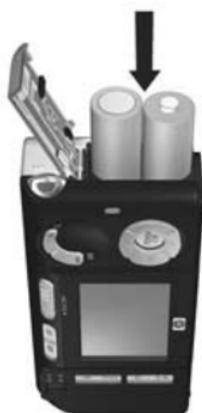
Wenn Sie keine optionale Speicherkarte einsetzen möchten, schließen Sie das Batterie-/Speicherkartenfach, indem Sie die Klappe nach unten drücken und in Richtung Kameraoberseite schieben, bis sie einrastet. Fahren Sie anschließend mit dem Abschnitt **Einschalten der Kamera** auf Seite 13 fort.
