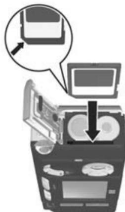
Wenn Sie die Speicherkarte aus der Kamera nehmen möchten, schalten Sie die Kamera zunächst aus. Öffnen Sie die Klappe des Batterie-/Speicherkartenfachs, und drücken Sie die Oberkante der Speicherkarte nach unten. Daraufhin springt die Karte aus dem Steckplatz heraus.
