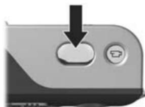
Das aufgenommene Bild erscheint für einige Sekunden auf der Bildanzeige. Diese Funktion wird als **Sofortkontrolle** bezeichnet. Sie können das Bild während der **Sofortkontrolle** löschen, indem Sie die Taste **Menu/OK** (Menü/OK) drücken.
