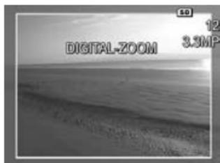
Die auf der rechten Seite angezeigte **Auflösung** wird bei Verwendung des Digital-Zooms kleiner. Beispielsweise wird der Wert **3,3 MP** anstelle des Werts **4 MP** angezeigt. Dies bedeutet, dass das Bild mit einer Auflösung von 3,3 Megapixel aufgenommen wird.
