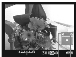
Blocco AE Posizione dell'area ingrandita Ingrandimento
