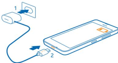
2. Ist der Akku vollständig aufgeladen, trennen Sie das Ladegerät erst vom Telefon und dann von der Steckdose.
