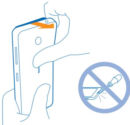
Verwenden Sie keine spitzen Werkzeuge, da diese das Display beschädigen können.
