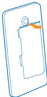
4. Schieben Sie die SIM-Karte in das SIM-Fach. Achten Sie dabei darauf, dass die Seite mit den Metallkontakten nach unten zeigt.
