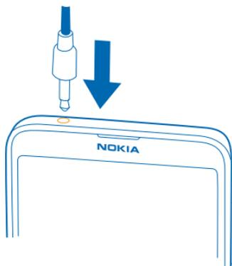
Schließen Sie keine Produkte an, die ein Ausgangssignal erzeugen, da das Gerät dadurch beschädigt werden kann. Schließen Sie keine Spannungsquelle an den Audioanschluss an. Achten Sie besonders auf die Einstellung der Lautstärke, wenn Sie ein externes Gerät oder Headset, das nicht für die Verwendung mit diesem Gerät zugelassen wurde, an den Audioanschluss anschließen.
