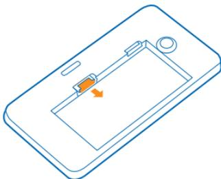
5. Um die Speicherkarte zu entfernen, ziehen Sie sie aus dem Einschub heraus.
