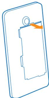
4. Um die SIM-Karte zu entfernen, ziehen Sie sie aus dem Einschub heraus.
