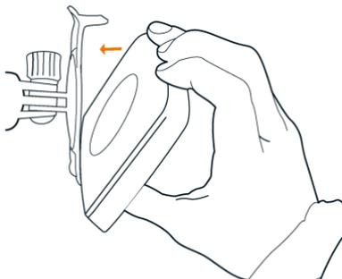
1. Setzen Sie das Navigationsgerät in die unteren Nasen der Halterung ein. (Siehe Abbildung)
