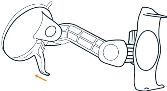
1. Reinigen Sie die Stelle der Windschutzscheibe, an der Sie die Halterung anbringen möchten. Sie muss trocken und frei von Verschmutzungen und Fett sein.
