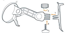
Setzen Sie die Halterung so zusammen, wie es in der Abbildung dargestellt ist. Sie benötigen dazu kein Werkzeug.
