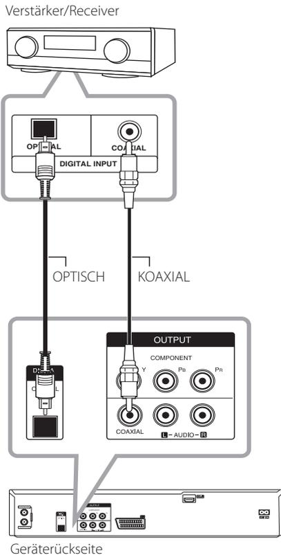
1. Verbinden Sie die DIGITAL AUDIO-Ausgangsbuchse (COAXIAL oder OPTICAL) des Rekorders mit der entsprechenden Buchse am Verstärker. Verwenden Sie dazu ein zusätzliches digitales Audiokabel (optisch oder koaxial).
