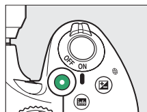
Taste für Filmaufzeichnung Aufnahmesymbol
