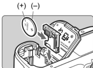
**5** Inserire il supporto della batteria.
