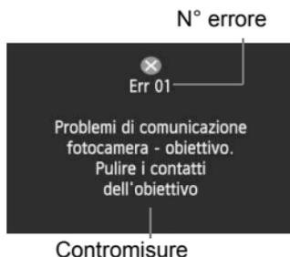
Se si verifica un problema con la fotocamera, viene visualizzato un messaggio di errore. Seguire le istruzioni visualizzate sullo schermo. Per eliminare il messaggio di errore, posizionare l'interruttore di accensione su <OFF> e <ON> o rimuovere e reinstallare la batteria.
