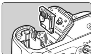
**4** Sostituire la batteria.
