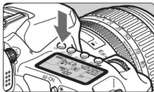
Ogni volta che si preme il pulsante <☀>, l'illuminazione del pannello LCD viene attivata o disattivata (☀). Durante l'esposizione posa, se si preme a fondo il pulsante di scatto, l'illuminazione del pannello LCD viene disattivata.
