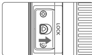
È possibile impedire che l'anello dello zoom si allunghi mentre si trasporta la fotocamera. Impostare l'anello dello zoom sul valore di grandangolo di 18 mm, quindi far scorrere la leva di blocco dell'anello dello zoom su <LOCK>. È possibile bloccare l'anello dello zoom solo se impostato sul valore massimo di grandangolo.
