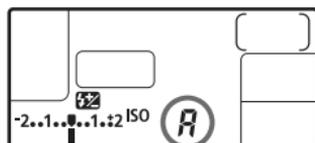
Se la velocità ISO è impostata su "**A**", la velocità ISO effettiva da impostare viene visualizzata quando si preme il pulsante di scatto a metà. Come indicato di seguito, la velocità ISO viene impostata automaticamente in base alla modalità di scatto.
