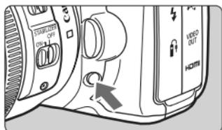
Premere il pulsante del controllo visivo della profondità di campo per mantenere l'impostazione di apertura corrente. È possibile controllare la profondità di campo (area di messa a fuoco accettabile) attraverso il mirino.
