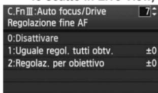
È possibile effettuare regolazioni dettagliate per il punto di messa a fuoco AF. È possibile effettuare la regolazione in  $\pm 20$  passi (-: Avanti/+ : Indietro). La quantità di regolazione effettuata in un passo dipende dall'apertura massima dell'obiettivo. **Regolare, scattare (▲ L) e verificare la messa a fuoco.**
