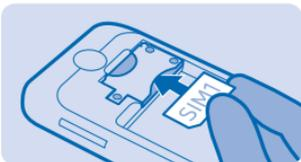
4. Per inserire una seconda SIM, spingere la SIM con l'area di contatto rivolta verso il basso fino a bloccarla in posizione.
