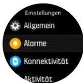
3. Wenn die gewünschte Einstellung hervorgehoben ist, wählen Sie sie mit der Mitteltaste aus. Durch Drücken der linken unteren Taste gelangen Sie zurück ins Menü.
