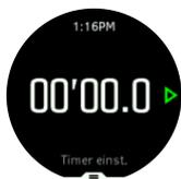
Stoppen Sie die Stoppuhr durch Drücken der Mitteltaste. Zum Fortsetzen drücken Sie die Mitteltaste erneut. Zum Zurücksetzen drücken Sie die untere Taste.
