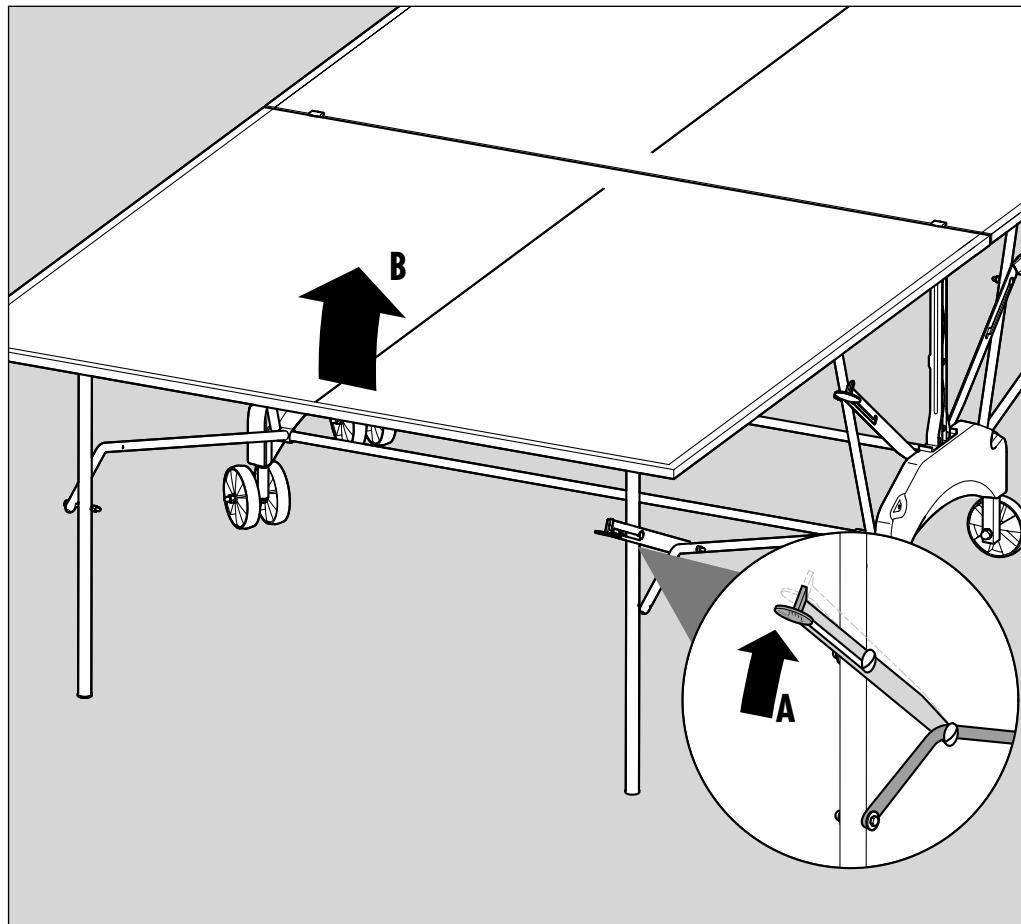
**D** Drücken Sie den Hebel der Standsicherung nach oben und heben Sie die Plattenhälfte an. Behalten Sie in der Anfangsphase des Hochklappens den Druck bei.
