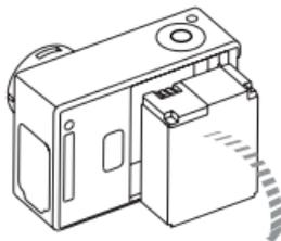
1. Nehmen Sie den Akkudeckel ab, indem Sie den Daumen in die Vertiefung des Akkudeckels (an der Rückseite der Kamera) legen und diesen nach links schieben.
