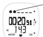
Fitness-Punkte - ein Punkt steht für 10 Minuten Training in der Herzfrequenz-Zielzone (ein blinkender Punkt zeigt einen angebrochenen 10-Minutenabschnitt an). Wenn alle Punkte erscheinen, trainieren Sie bereits eine Stunde in Ihrer Zielzone.
