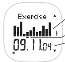
Die grafischen Balken stehen für die durchgeführten Trainingseinheiten. Die Höhe der Balken zeigen die Trainingsdauer an.
