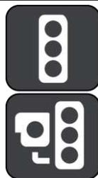
**Ampelkamera** – Dieser Radarkameratyp überwacht das Haltegebot an einer roten Ampel. Es gibt zwei Arten von Ampelkameras: solche, die überprüfen, ob Sie eine rote Ampel überfahren, und solche, die prüfen, ob Sie eine rote Ampel überfahren und gleichzeitig Ihre Geschwindigkeit prüfen.
