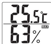
Humidité relative de l'air maximale à l'intérieur
