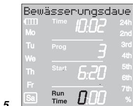
5. Bewässerungsdauer-Stunden mit dem Drehknopf einstellen (Bsp. **0** Stunden) und mit der **OK-Taste** bestätigen.
