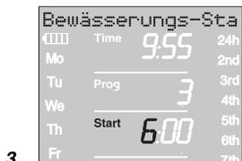
3. Bewässerungsstartzeit-Stunden mit dem Drehknopf einstellen (Bsp. **5** Stunden) und mit der **OK-Taste** bestätigen.
