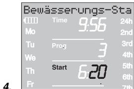
4. Bewässerungsstartzeit-Minuten mit dem Drehknopf einstellen (Bsp. **20** Minuten) und mit der **OK-Taste** bestätigen.
