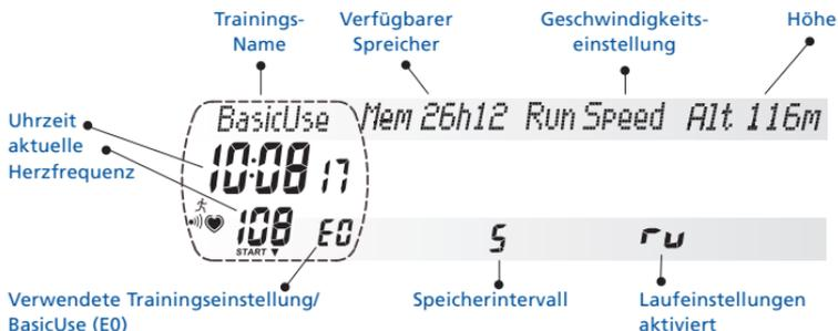
Wenn Sie die Geschwindigkeits-Funktionen nicht nutzen wollen, schalten Sie die Geschwindigkeits-Funktionen aus, indem Sie die DOWN-Taste lange gedrückt halten. Wiederholen Sie dies, bis -- auf dem Display erscheint. Durch das Ausschalten der Geschwindigkeits-Funktion haben Sie mehr Speicherkapazität.
