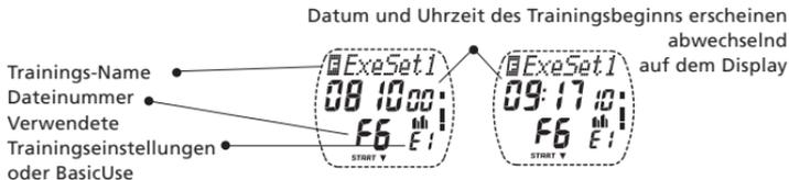
3. Drücken Sie kurz so oft die UP- oder DOWN-Taste, bis die gewünschte Datei angezeigt wird.
