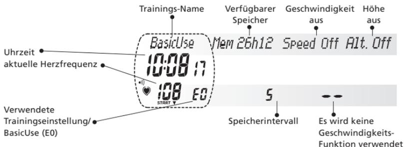
Wenn Sie laufen oder Rad fahren, stellen Sie die Geschwindigkeits-Funktionen ein, indem Sie die DOWN-Taste lange gedrückt halten. Wiederholen Sie diesen Vorgang, bis die richtige Einstellung in der rechten unteren Ecke des Displays erscheint.
